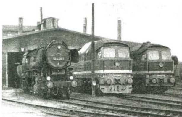
Bild 2 Der Traktionswechsel war bereits zum Zeitpunkt dieser Aufnahme deutlich sichtbar. Eine 52.8 neben sowjetischen Großdieselloks vor dem Bw Röblingen
