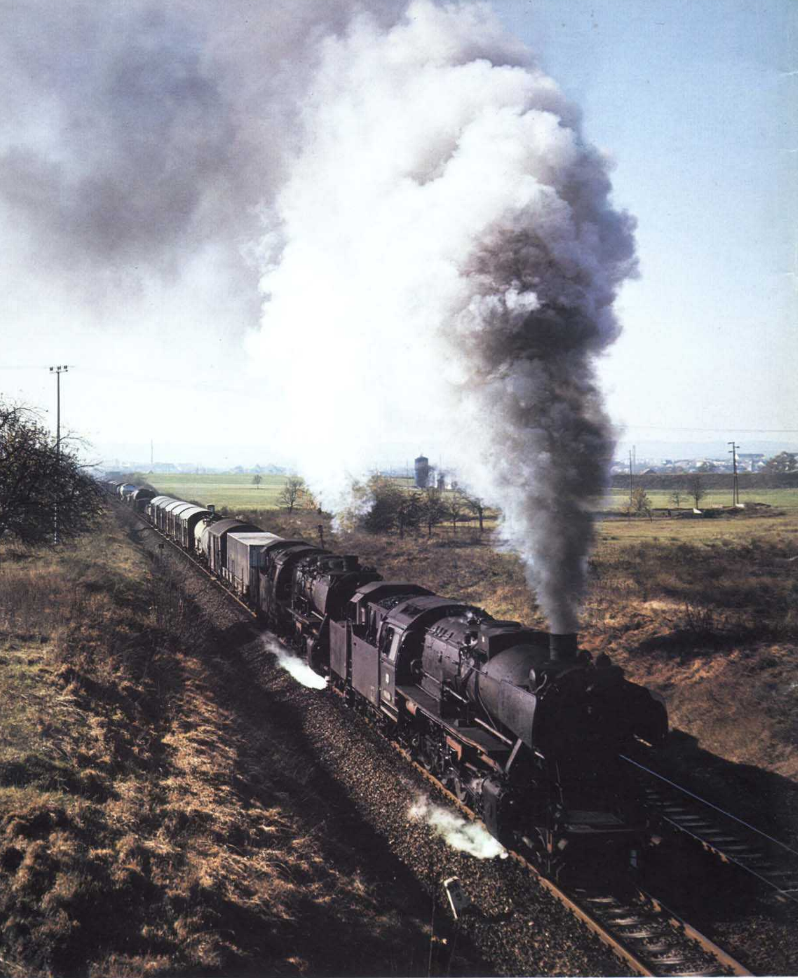
Nach dem Bahnhof Hessental schließt sich in Richtung Crailsheim eine lange Rampe an. Schwere Güterzüge mußten hier mit Vorspann gefahren werden. Das im Dezember 1972 aufgenommene Bild zeigt die 050 406 vor einer Schwesterlok mit Kabinentender.
