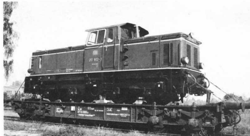
Bild 8: Mit Schmalspur-Transportwagen werden die Schmalspurdieselloks bei fälligen Untersuchungen von Warthausen zum AW Nürnberg transportiert. 251 902 am 7.10.1972 im AW Nürnberg. Foto: L. Mickel
