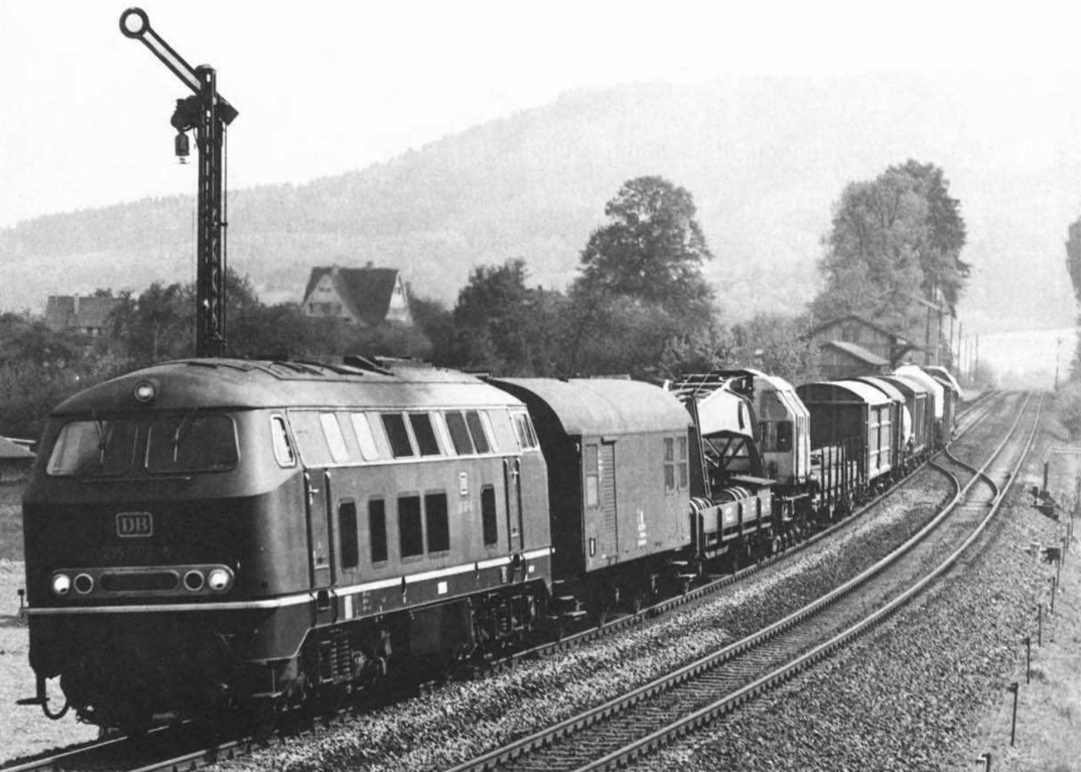
Bild 5: Viele der leichten Güterzüge und die meisten Reisezüge zwischen Schwäbisch Hall und Heilbronn wurden im Jahr 1973 von Diesellokomotiven der Reihe 215 geführt. Die bei Gallenkirchen fotografierte Lok 215 007 ist eine der zehn Vorserienmaschinen dieser Baureihe. Foto: Obermayer
