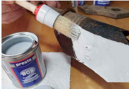
Innerhalb eines Tages mit der Grundierung überstreichen, danach endlackieren
