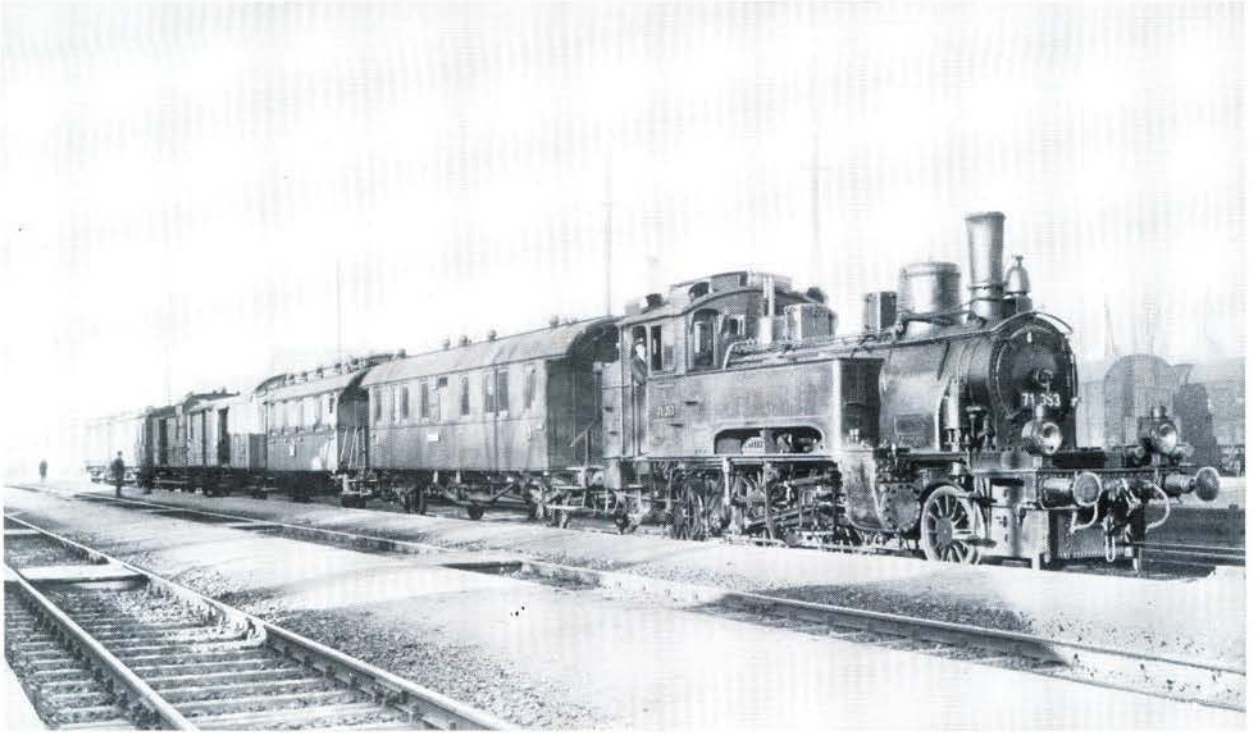
U. B. z. den Personenzug 3415, aufgenommen zu Beginn der 30er Jahre im Bahnhof Beucha an der Strecke Beucha—Trebsa/Mulde. Den Zug förderte die 71583 der DR. Diese Baureihe ist nicht mit der 71er-Einheitslokomotive der DR zu verwechseln. Vielmehr war es die ehem. sächs. Gattung IV T 1' B1' n2, die von der DR übernommen wurde, Baujahr 1909 (Hartmann).
