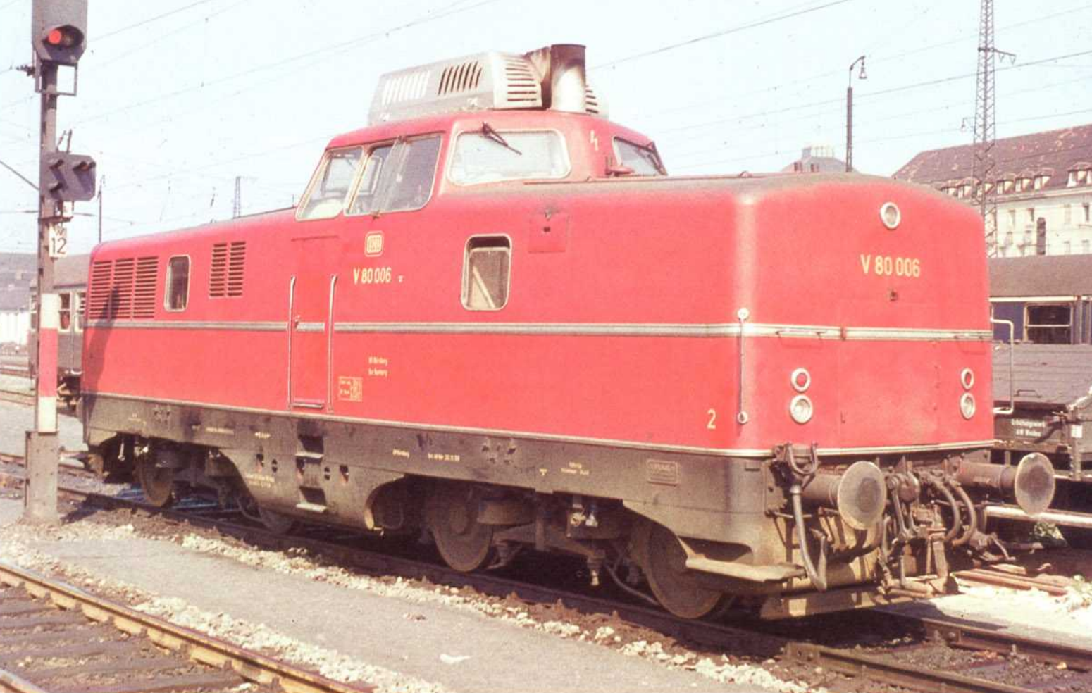
Bild 6: Um die lauten Auspuffgeräusche zu verringern, wurden die Diesellokomotiven der Baureihe V 80 in den späten fünfziger Jahren mit einem Schalldämpfer in Form eines Dachaufsatzes ausgerüstet. Bis 1968 wurden diese wieder entfernt, da sie sich nicht bewährt hatten. Die V 80 006 wurde im Juli 1963 in Nürnberg Hbf abgelichtet. Foto: A. Schöppner
