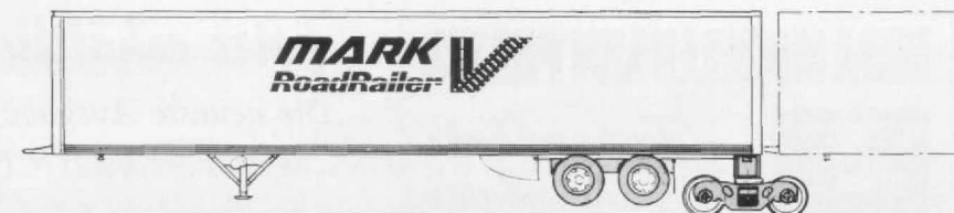
Abb. 3. Für leichtere Achslasten umkonstruiert: Road-Railer mit Drehgestell (Skizze in 1/2 H0-Größe).
