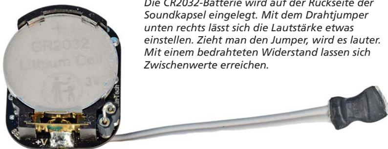
Die CR2032-Batterie wird auf der Rückseite der Soundkapsel eingelegt. Mit dem Drahtjumper unten rechts lässt sich die Lautstärke etwas einstellen. Zieht man den Jumper, wird es lauter. Mit einem bedrahteten Widerstand lassen sich Zwischenwerte erreichen.
