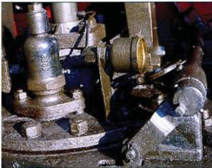
Über ein Hebelsystem wird der Druckausgleich für die Zylinder bedient.
