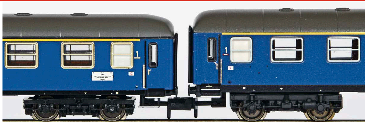
Fleischmann: Höhenvergleich zwischen dem neuen Aüm 203 links und einem viel zu hoch liegenden Wagen aus alter Fleischmann-Produktion. Auch ist das neue Drehgestell maßstäblicher und feiner detailliert
