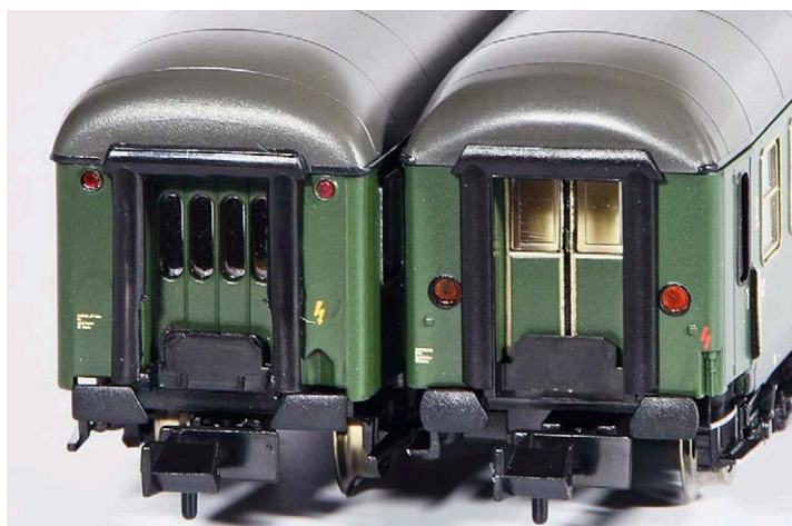
Fleischmann: Der BRymb links hat noch Falttüren und Schlusslichter oben, rechts der neue Büm mit Schiebetüren und tiefer liegenden Lampen
