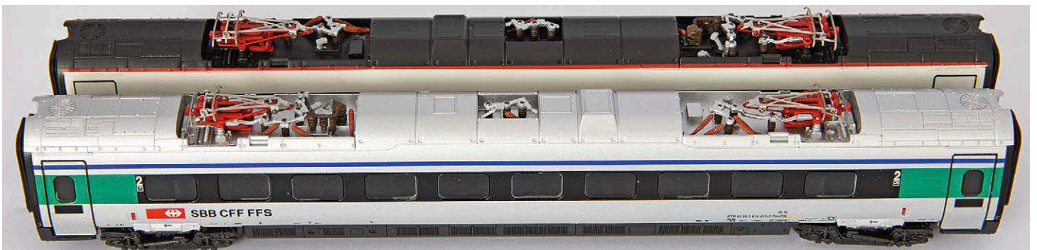
Arnold: Dachansicht der Mehrsystem-Zwischenwagen mit Stromabnehmern mit schmalem und breitem Schleifstück
