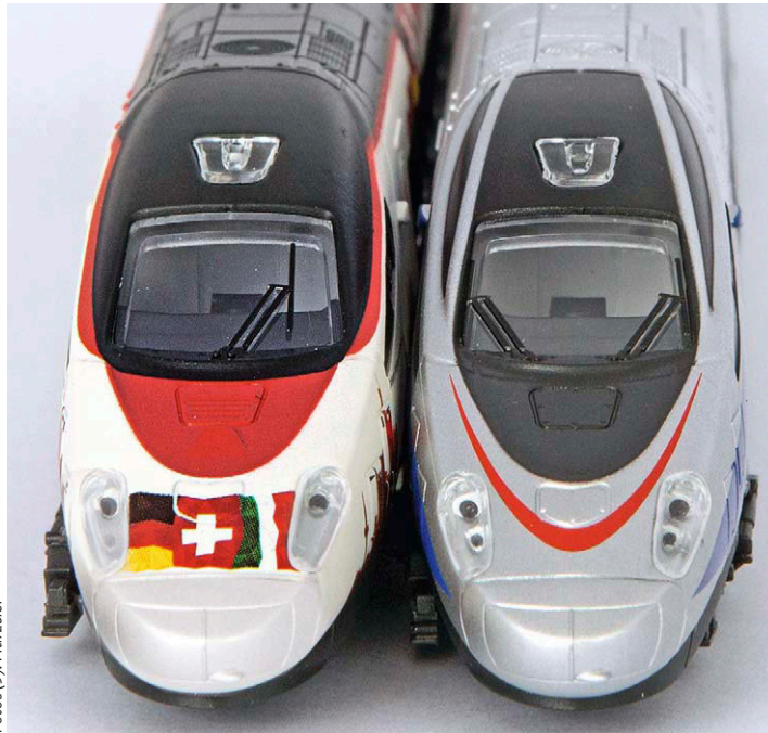
Arnold: Frontvergleich zwischen dem ETR 610 und dem RABe 503. Gut sichtbar sind die unterschiedlich ausgeprägten Bugklappen, Scheinwerfer und die verschiedenen Scheibenwischer
