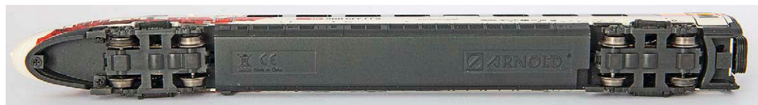
Arnold: Der Antriebsteil (hier SBB RABe 503) von unten, die Getriebe sind komplett gekapselt. Die beiden äußeren Radsätze tragen einen Haftreifen
