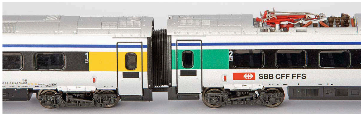
Arnold: Die Wagenenden sind mit leicht federnden Übergängen ausgerüstet, welche im geschobenen Zustand bündig schließen
