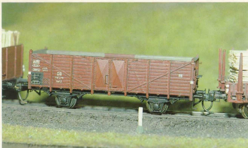
Bild 2. Dieses H0-Modell eines Om 12, wie er als Großserien-Modell unbedingt benötigt wird, entstand durch Umbau eines Om 21 von Roco; die Beschriftung stammt von Gaßner.
