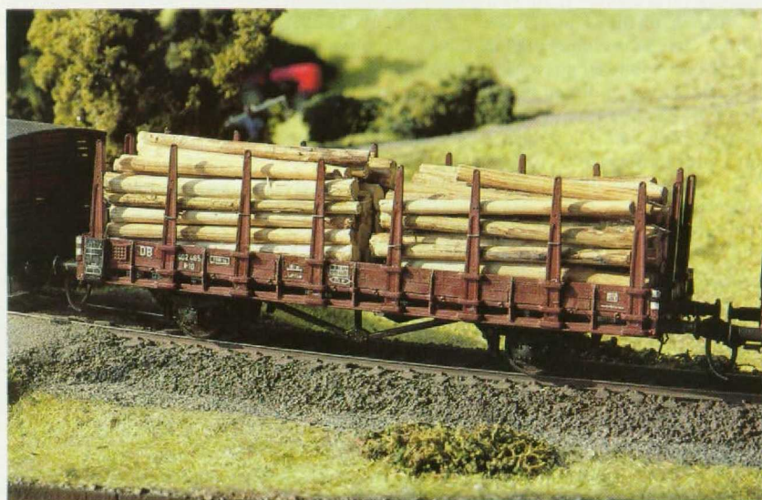
Bild 3. Ein Rungenwagen der Verbandsbauart im Modell. Basis für den Umbau war ein Piko-Wagen, bei dem die Bordwände niedriger geschnitten wurden und eine Holzverkleidung erhielten. Die Beschriftung ist wiederum von Gaßner, die Stammholz-Ladung entstand aus geschälten echten Zweigen.
