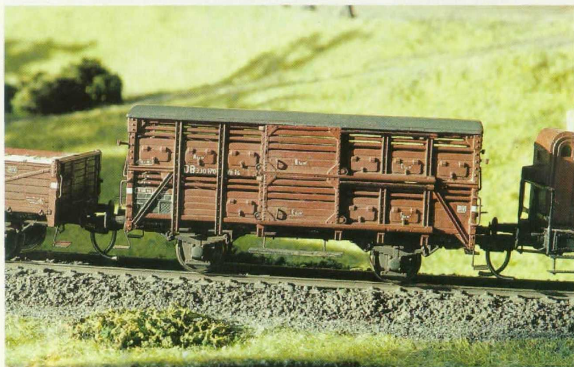
Bild 4. Vor vielen Jahren hatte Trix ein maßstäbliches Modell eines Vh 14 im Programm. Mit Zurüstteilen von Weinert, neuen Türen (Fleischmann), neuem Fahrwerk (Roco) und neuer Beschriftung (Gaßner) entspricht der Wagen fast heutigem Fertigungsstandard; dennoch ist eine Neuauflage dringend erforderlich.
