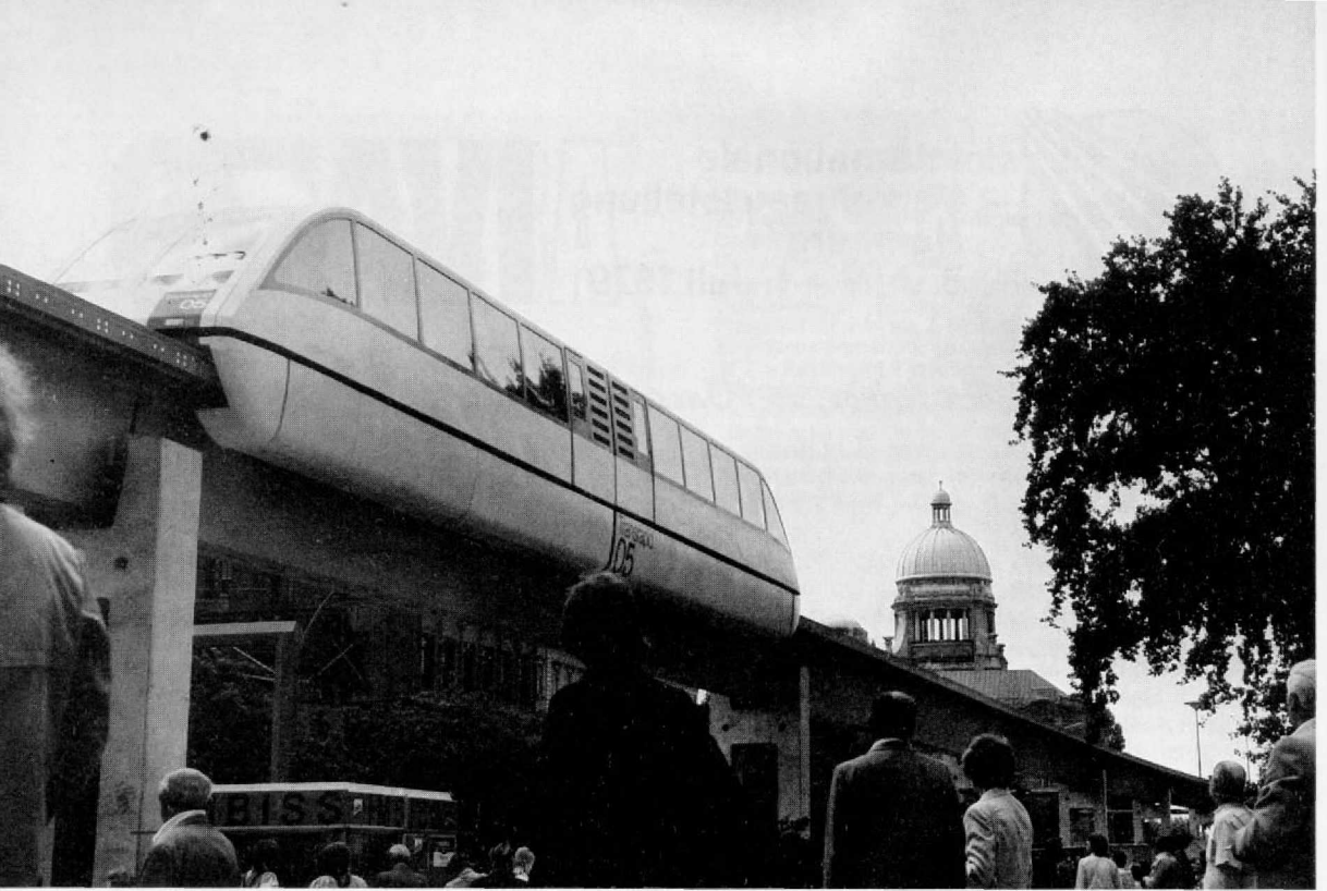
Abb. 2. In der Luft schwebte über den Köpfen der IVA-Besucher der „Transrapid 05“ auf der 900 m langen Strecke von den Ausstellungshallen zum Freigelände und zurück. Die ersten öffentlichen Fahrten eines Magnetschwebezuges in der Bundesrepublik waren während der gesamten Ausstellungsdauer permanent ausgebaut, und selbst die MIBA-Redaktion kam nur mit knapper Not zu „Schwebe-Ehren“. Mehr über Schwebebahnen in Heft 9/79!
