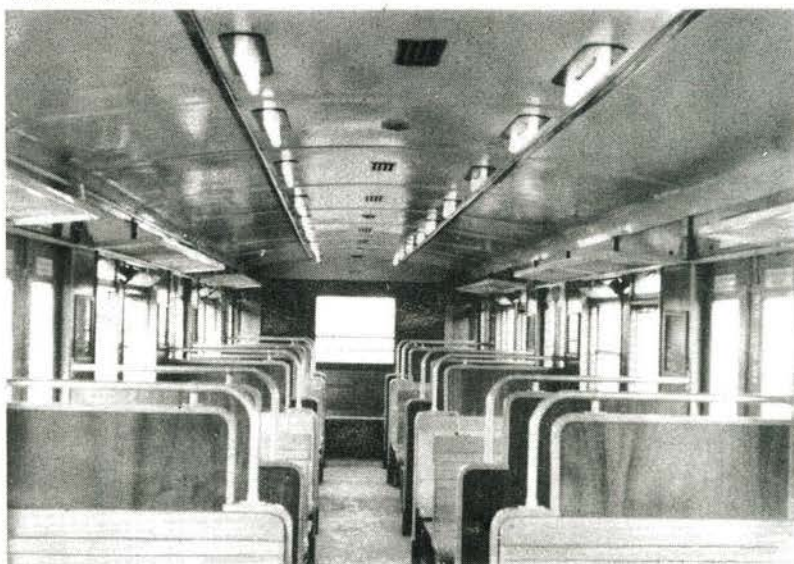
Bild 3 Gestaltung und Anordnung der Hochspannungsröhren Typ G 505, hier im EB 165 475. Beim Typ Gu 900 war die Röhre u-förmig gebogen und mit einer Glasschale abgedeckt. Beide Typen sind heute nicht mehr in Betrieb.
