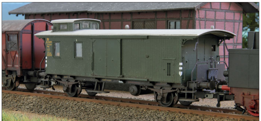
Ein typischer Güterzuggepäckwagen einer Länderbahnbauart war der Pwgi wü 09. Er hat schon die klassische Aufteilung zwischen Dienstbereich (hinten) und Frachtbereich (vorn). Auch eine erhöhte Dachkanzel gehört schon dazu, fehlen durfte auch nicht das Kleintierabteil, vorzugsweise für mitzunehmende Hunde. Modell: R. Becker
