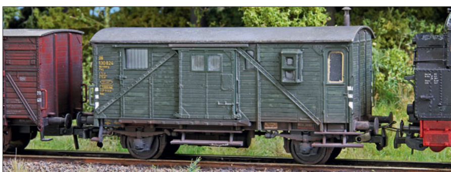
Auf der Basis eines neueren Modells von Fleischmann entstand dieser PwG pr 14 mit Diagonalversteifungen, zusätzlichen Fensteröffnungen in den Türen und ohne Dachkanzel. Das kleine Erkerfenster steuerte Weinert bei, die Profile für die Verstärkungsdiagonalen sind von Makett erhältlich. Modell: R. Becker
