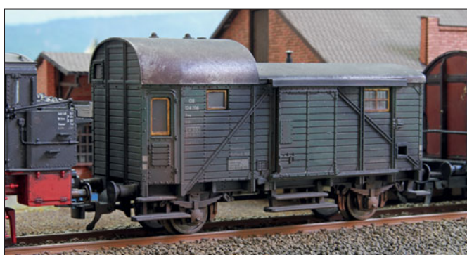
Ein Märklin-Modell eines „frühen“ PwG pr 14 noch ohne die Diagonalversteifungen, die von der DB zur Verstärkung und Stabilisierung des Wagenkastens angebracht wurden.
