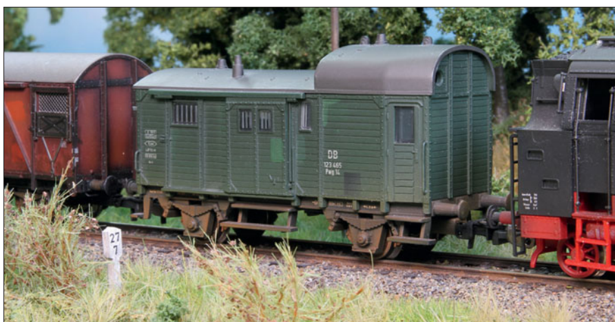
Ein Märklin-Modell eines „frühen“ PwG pr 14 noch ohne die Diagonalversteifungen, die von der DB zur Verstärkung und Stabilisierung des Wagenkastens angebracht wurden.
