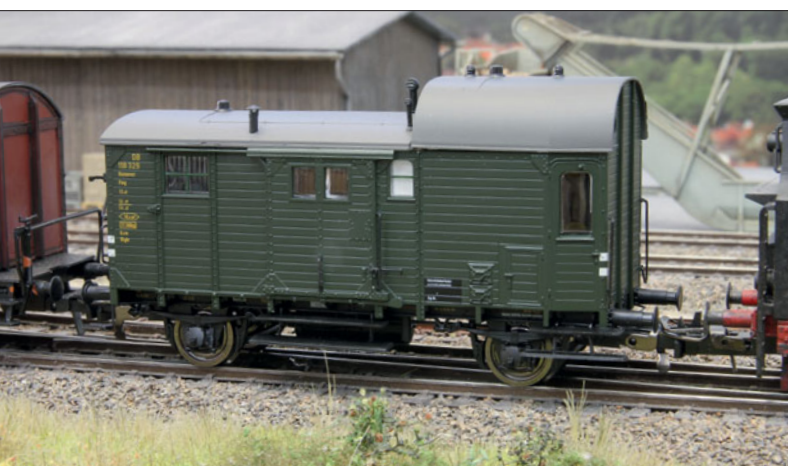
Auf der Basis eines neueren Modells von Fleischmann entstand dieser PwG pr 14 mit Diagonalversteifungen, zusätzlichen Fensteröffnungen in den Türen und ohne Dachkanzel. Das kleine Erkerfenster steuerte Weinert bei, die Profile für die Verstärkungsdiagonalen sind von Makett erhältlich. Modell: R. Becker
