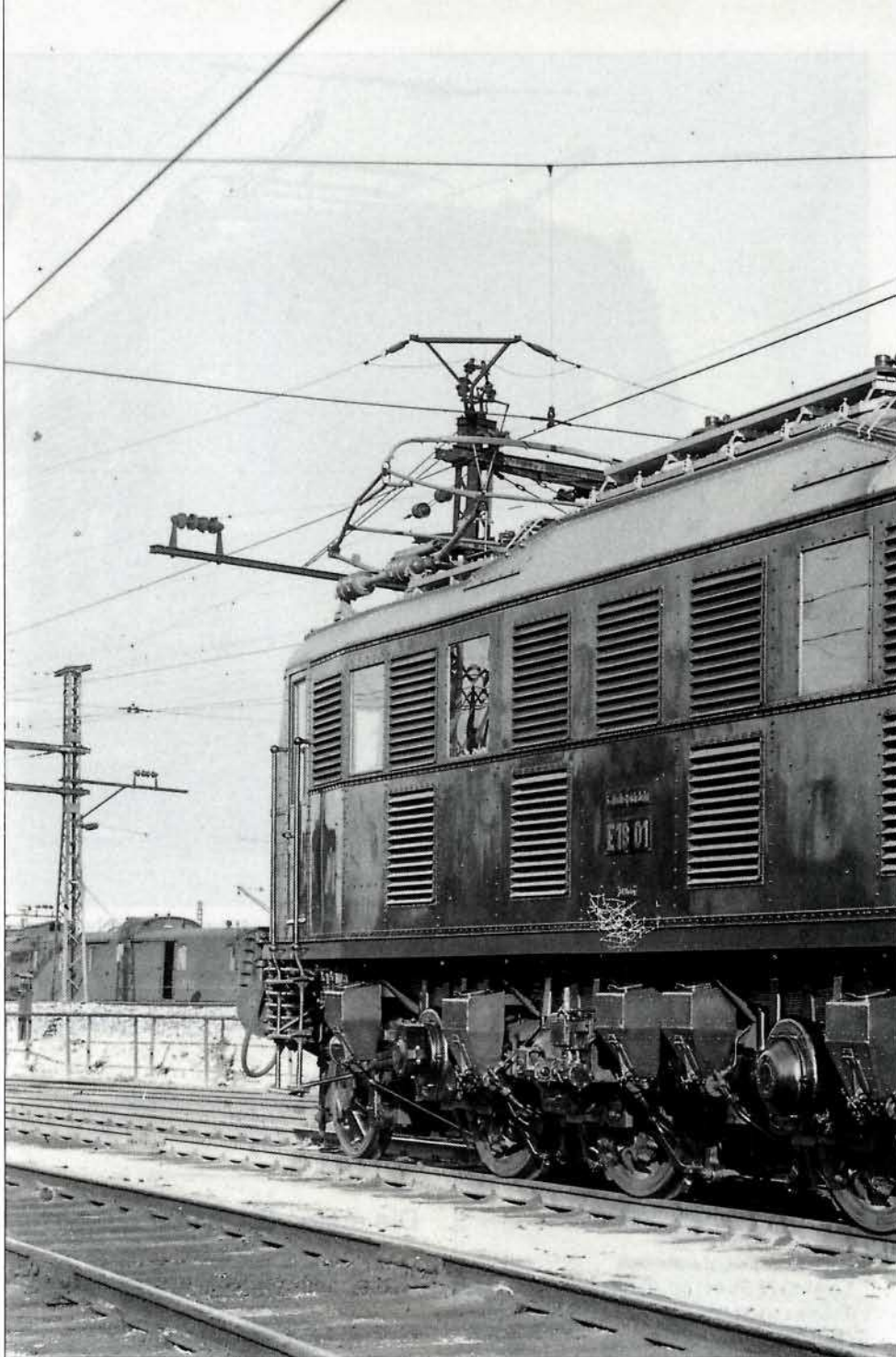
Bild 3: Die E 18 01 kurz nach ihrer Anlieferung im Mai 1935 in München, ohne Schürzen und Handstangen unter den Stirnfenstern. Foto: H. Maey, Sammlung Dr. Scheingraber
