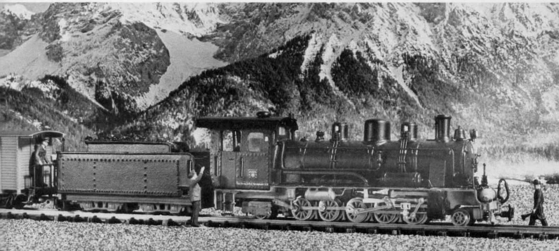
Abb. 2 u. 3. Der „jüngste Sproß“ des selben Modellbauers: ein superdetailliertes H0e-Modell einer Schmalspurlok (Minitrix-52-Fahrwerk, Aufbau aus Vollmessing und Messingblech). Das Vorbild ist eine 1'E1'-Lok der Heeresfeldbahnen, wie sie damals auf fast allen Kriegsschauplätzen – sicher auch vor einer ähnlichen Kulisse wie auf Abb. 3 – zu finden war.
