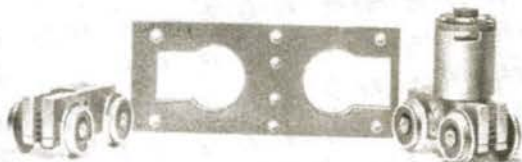
Bild 2 Die 3 Hauptteile des Triebtenders; linkes Triebgestell noch ohne Motor, Stromabnehmeraufnahme und Haftreifen
