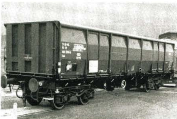
Bild 4 Dieser vierachsige Ganzstahlwagen aus Arad (SR Rumänien) ist besonders durch sein hohes Fassungsvermögen und die im Fußboden befindlichen Selbstentladeeinrichtungen gekennzeichnet. Seitlich werden die Öffnungsschieber von Hand über eine durchgehende Welle betätigt. Einige Maße des Wagens: Länge über Puffer 14540 mm, maximale Auslastung 58 t, Eigenmasse 21,72 t.
