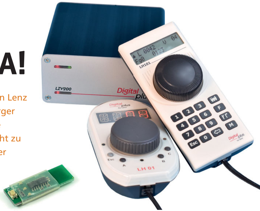
Die grüne Platine links ist ein Update-Stick. Ich bin schon sehr gespannt auf das erste Update. Vielleicht taugt das Konzept ja auch für andere Dinge, wie zum Beispiel einen Lokschlüssel?
