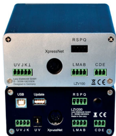
Oben ist die alte Zentrale LZW100, unten die neue LZV200 zu sehen. Auf der Rückseite der neuen Zentrale ist es richtig voll geworden. Neu sind die USB-Schnittstelle, der Update-Anschluss und der Anschluss für ein Schaltnetzteil.
