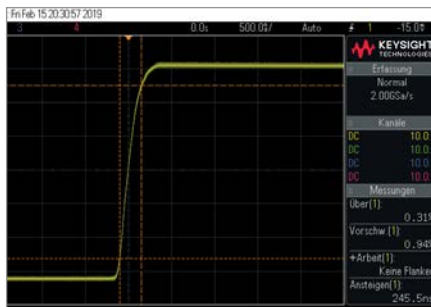
Das Ausgangssignal der LZV200 kann durch eine wunderschöne Form überzeugen und hält alle elektrischen Werte ein, die NMRA und RailCommunity fordern.
