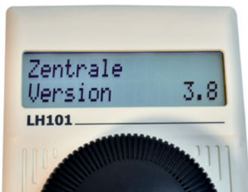
Der Handregler LH101 verrät es: In der neuen Zentrale LZV200 werkelt schon die neue Version 3.8 des XpressNet-Protokolls von Lenz.
