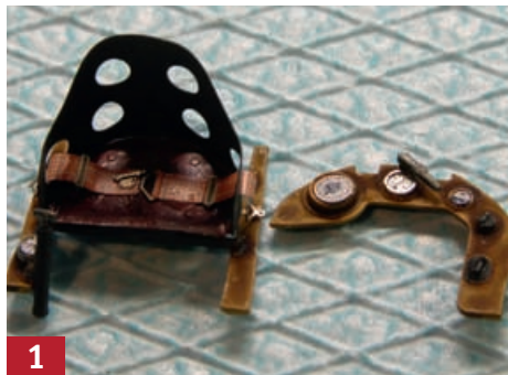
Der fotogeätzte Sitz, ausgerüstet mit geätzten Sicherheitsgurten. Die Zifferblätter der Instrumente sind ebenfalls Fotoätzteile.
