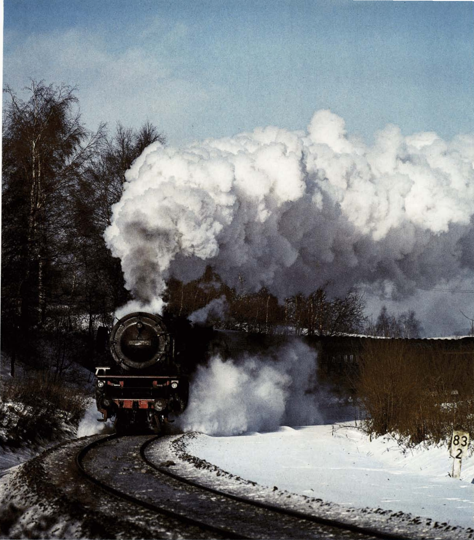
Bild 5: Beim Goldberg, an der Strecke Bamberg – Hof, war die 001 131 am 9. 1. 1971 mit dem D 853 unterwegs. Die Lokomotive hatte ihren Neubaukessel erst bei einem Kesseltausch im Januar 1966 im AW Nied erhalten.
