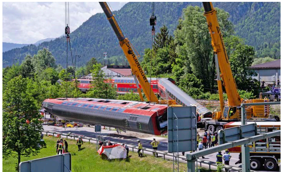
Am 3. Juni entgleist ein RE mit 111 und Doppelstockwagen bei Garmisch-Partenkirchen. Fünf Menschen sterben, die Strecke Garmisch-Partenkirchen – Murnau bleibt bis November gesperrt. Die vermutete Ursache: Schäden an den Betonschwellen. PICTURE-ALLIANCE/DPA
