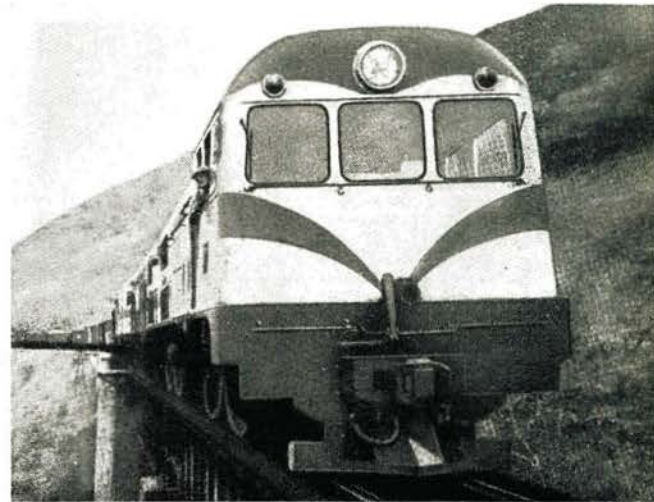
Bild 2 Co-Co dieselelektrische Lokomotive 96 Mp Last, 80 km/h Höchstgeschwindigkeit, 1750 PS Leistung
