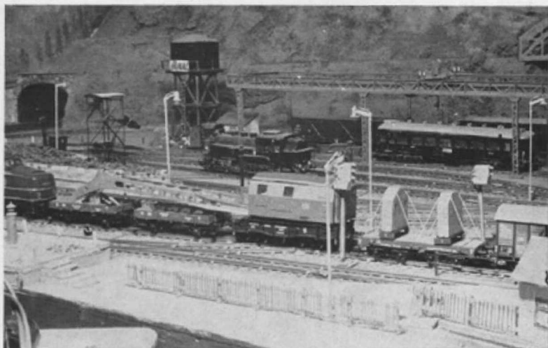
Abb. 9. Zum Kranwagen gehören: ein Gegengewichtswagen mit 2 Rollböcken, 2 Wagen für den Ausleger und ein Gerätewagen, in welchem sich ein Märklin-Umsteuerschütz (durch Stromstoß fernsteuerbar) zum Ein- und Ausschalten des Kranmotors befindet.
