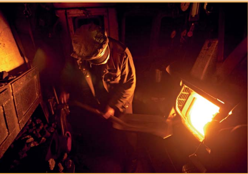
Als sich die Feuertür öffnet, erhellt ein gleißender Feuerschein den Führerstand. Immer wieder bugsiert der Heizer die Kohle in den Kessel.
