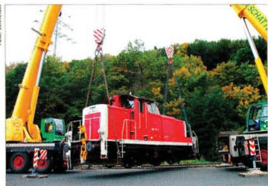
Die Verladung der 365 175 von der Schiene auf den Tieflader erfolgte in Kreuztal-Buschhütten.
