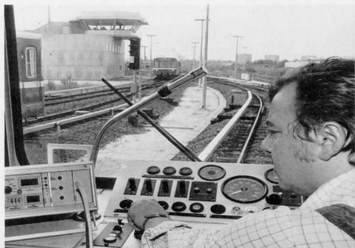
Abb. 5. Das Original-Foto zur Abb. 1, ohne die von uns hineinmontierte Digital-Anzeige des Modellbahn-Tachos. Das Gerät links ist in Wirklichkeit ein neuentwickelter Bremswegmesser für elektronisch gesteuerte Triebwagen; daß es sich nicht um den Tacho handelt, dürften aufmerksame Leser schon am „echten“, auf „0“ stehenden Tacho erkannt haben, dem runden Anzeige-Instrument links vom Gesicht des Lokführers. (Foto: Siemens)
