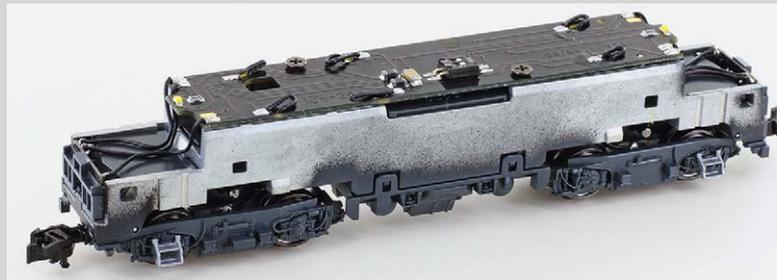
Die Neukonstruktion hat Fleischmann-typisch ein Metallgusschassis und einen Motor mit Schwungmasse sowie separate Platinen für die LED-Frontbeleuchtung
