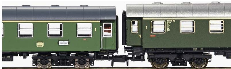
**Minitrix:** Die Göppinger Neukonstruktion liegt deutlich tiefer als das ältere Fleischmann-Modell (Bild oben). Dagegen passt der maßstäbliche Dreiachsler von Fleischmann sehr gut zum Minitrix-Modell
