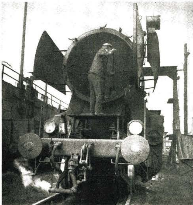
Bild 2 Großen Zeitaufwand erfordert auch das Ausschlacken dieser Maschinen, wie hier im Bw Wustermark 1978
