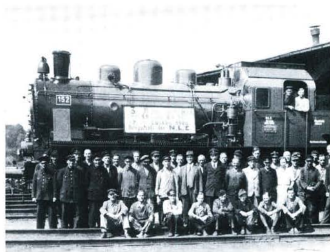
Bild 4 Ebenfalls für die Niederlausitzer Eisenbahn wurde diese recht moderne 1'C Heißdampflok von Henschel im Jahre 1936 mit der Fabrik-Nr. 23101 gebaut und mit der Betriebs-Nr. 152 eingesetzt. 1950 erhielt die Maschine die Bezeichnung 91 6492. 1970 sollte sie noch eine EDV-Nr. erhalten, wurde aber noch im gleichen Jahr in Leipzig-Wiederitzsch zerlegt.
