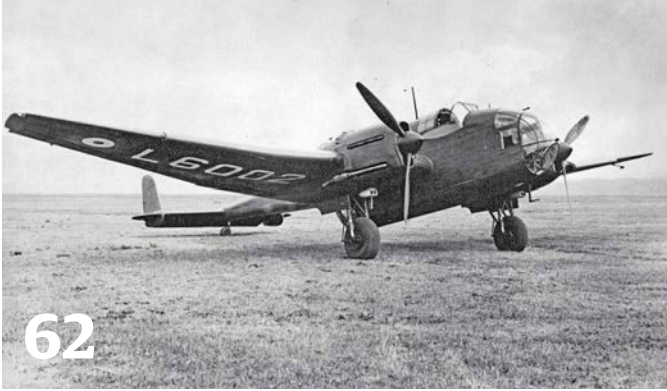
Die Hereford war eine mit einem Reihenmotor ausgerüstete Version der Hampden – und hatte einen »speziellen« Ruf
