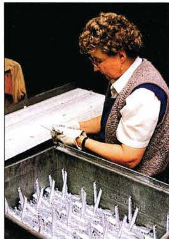
Nach jedem wesentlichen Produktionsschritt ist eine Qualitätskontrolle eingebaut. Hier die erste Station: Beim kleinsten Lunker zurück ins Schmelzbad.
