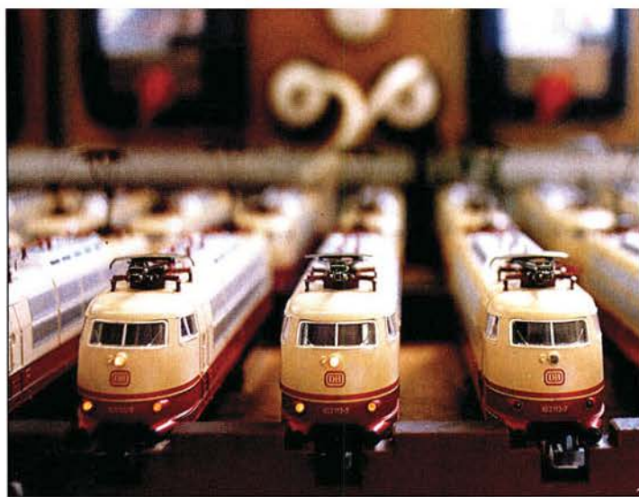
Kein Fahrzeug verläßt das Werk, bevor es 10 Minuten in beide Richtungen eingelaufen ist. Bei der rechten Lok muß die Beleuchtung nachgearbeitet werden.
