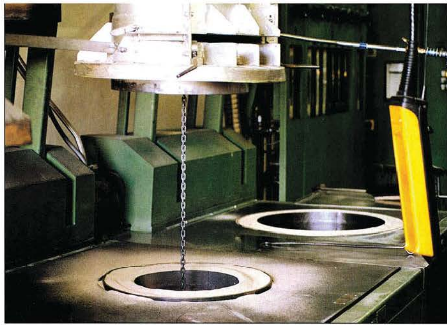
Wärmekegel links, stickstoffbeflutbare Transporthaube darüber, Härtekegel rechts.
