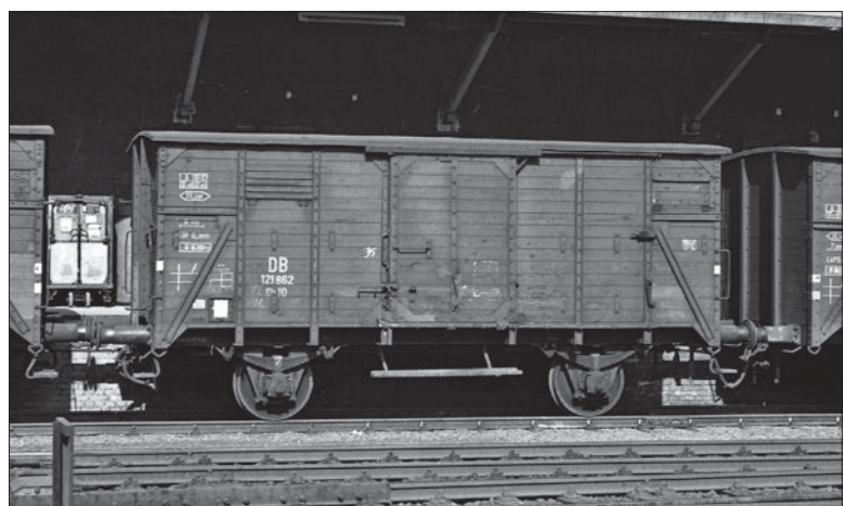
Der ungebremste Gh 10 121 862, aufgenommen im März 1961 in Unna, ist vermutlich schon vor dem Vlimms 63-Umbauprogramm aus einem Vh 14 entstanden. Foto Reinhardt Todt, Slg. Eisenbahnstiftung
