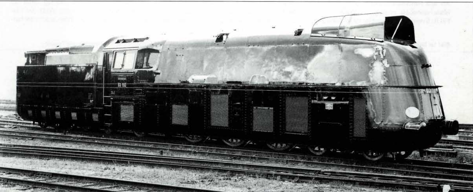
Bild 8: Die gleichzeitig mit der Baureihe 05 gefertigte 03 193 mit nahezu gleicher Stromschale, aufgenommen im Spätsommer 1935 bei Borsig. Foto: Sammlung Weisbrod
