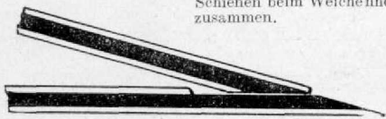
Abb. 2 So paßt Herr Chromek die Schienen beim Weichenherz zusammen.
