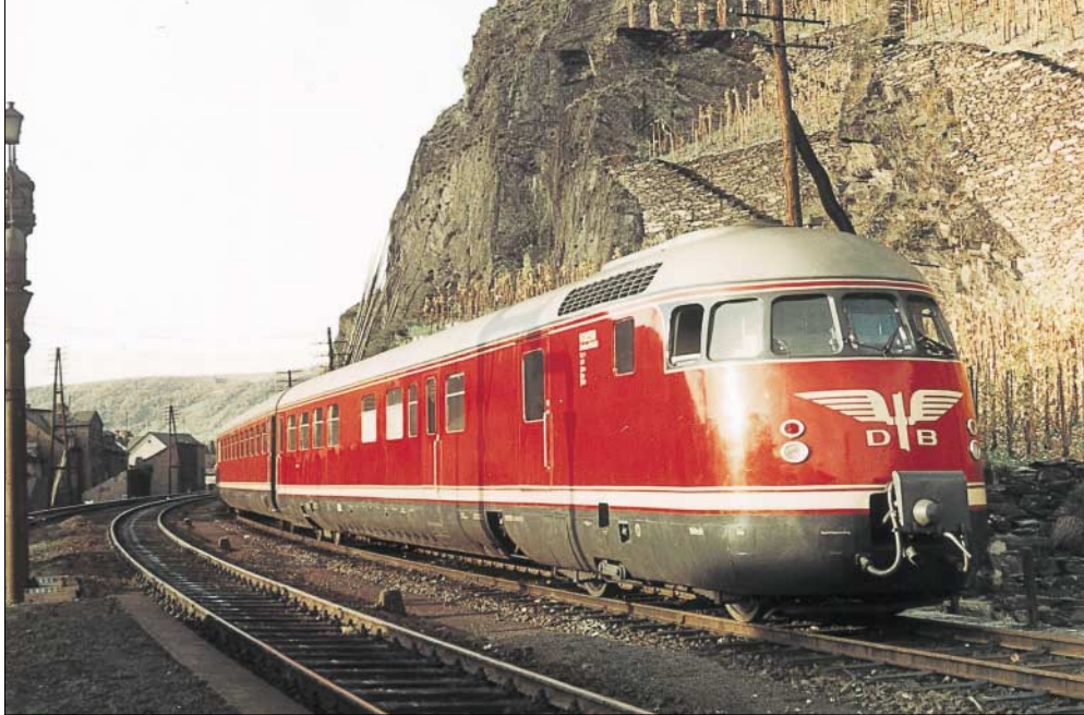
Im Jahr 1952 führte MAN mit dem nagelneuen VT 05 508 Probefahrten auf der rechten Rhein- strecke durch. Gut erkennbar die Fenster- aufteilung mit der Lücke zwischen Küche und Speiseabteil. Foto: MAN, Slg. Löttgers
