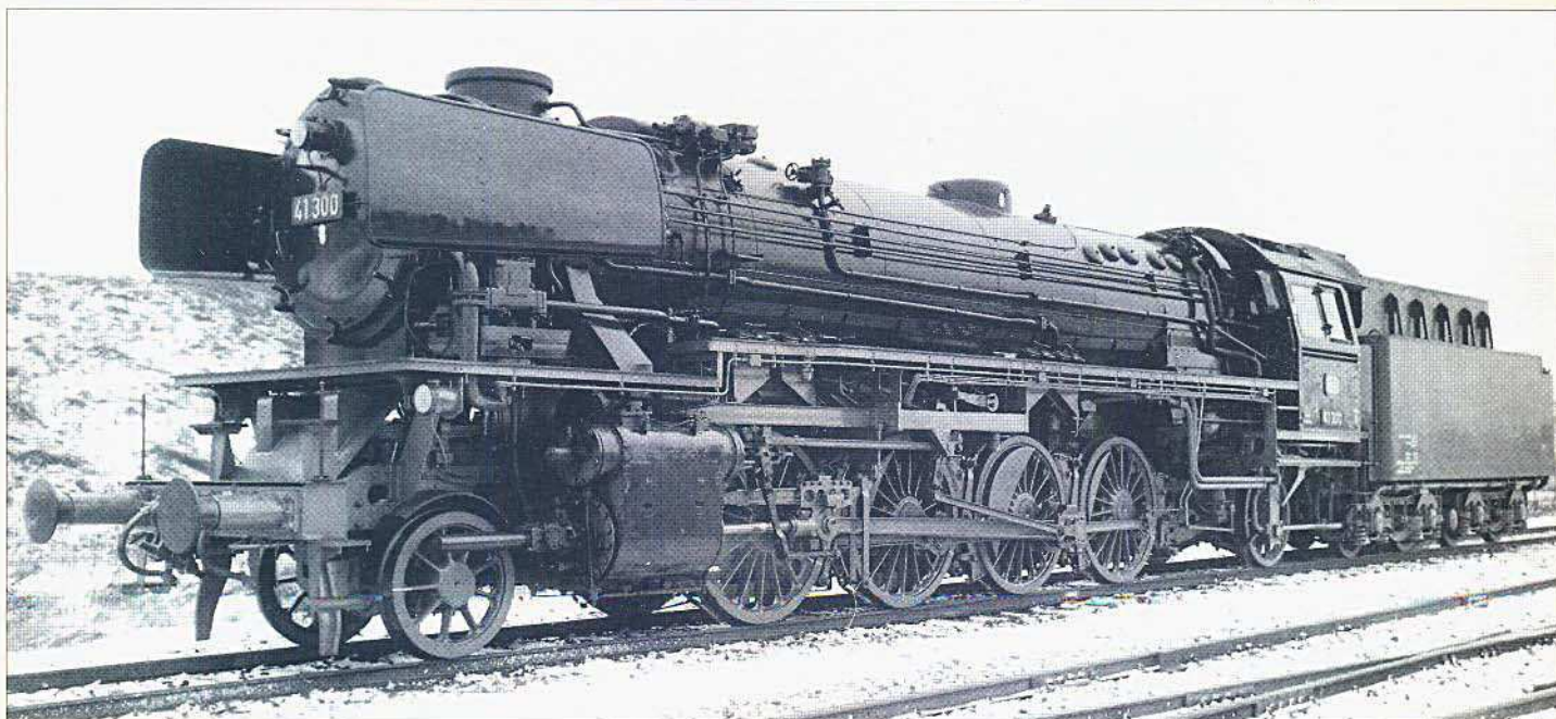
Bild 13: 41 300 der DB mit geschweißtem Ersatzkessel, Mischvorwärmer MV 57 und Einfachventil-Heißdampfregler.
