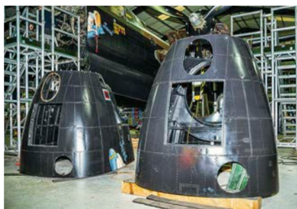
Alt gegen neu: Die Rumpfnase der NX611 wird mit jener der NX644 (rechts) getauscht
