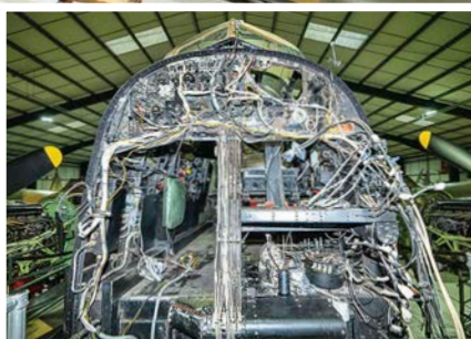
Seltener Einblick ins Innere einer Lancaster: Die NX611 mit abgenommener Rumpfnase
