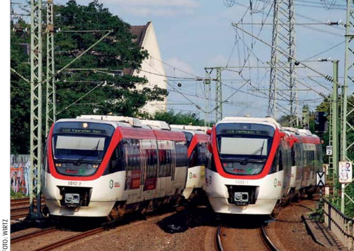
Auch innerhalb der Talent-Familie sind die Regiobahn-Fahrzeuge Exoten: Da die Bahnsteige an der Strecke eine Höhe von 96 Zentimetern haben, mussten die zwölf Triebwagen der Regiobahn höher gelegt werden.
