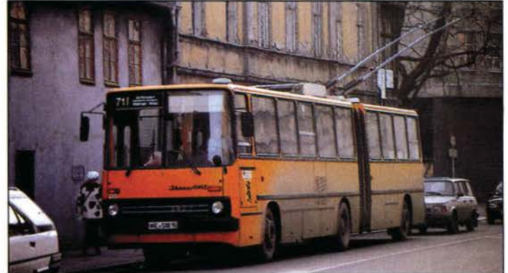
Ein kostenlos geliehener Obus aus Suhl am 7. Januar 1992 in Weimar. Der dortige Obus-Betrieb soll mittelfristig eingestellt werden. Die Gründe: abgängige Fahrleistungen, verschlissene Unterwerke und unmoderne Fahrzeuge.
