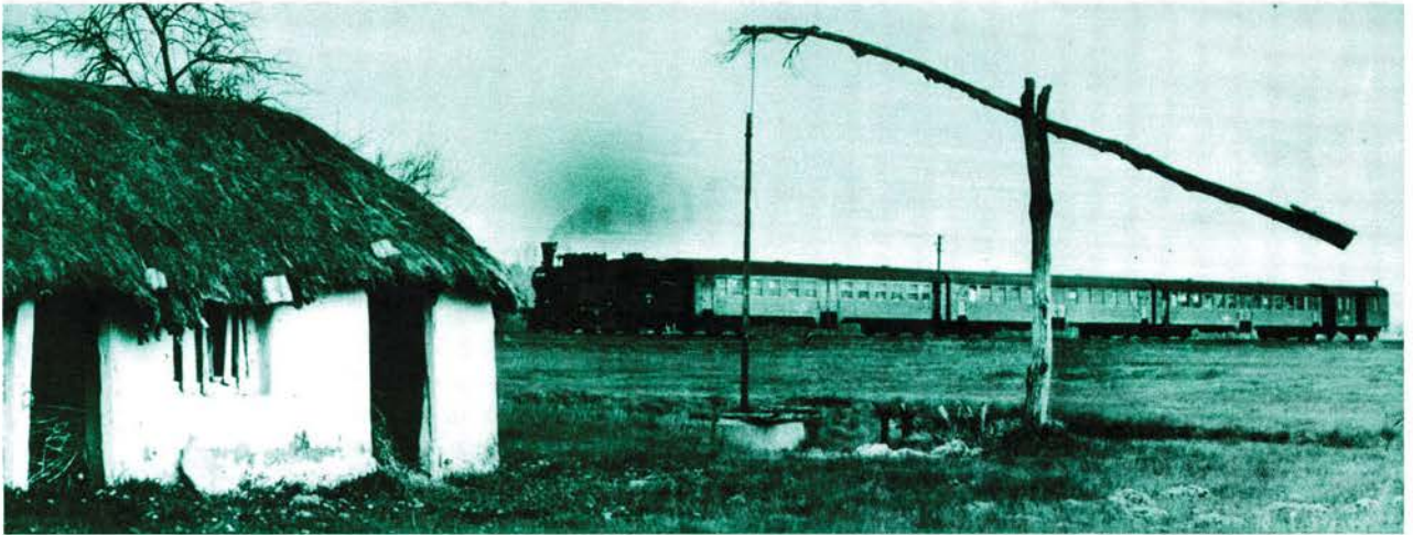
Bild 6 P4425, bespannt von einer 1'D 1' Dampflokomotive der ungarischen Baureihe 424, bei Szegi in Nordostungarn. Fotos: G. Feuereißer, Plauen
