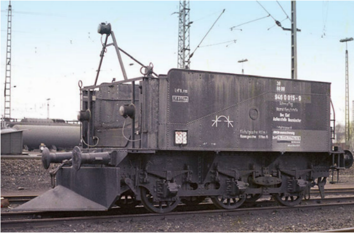
In Hamburg-Wilhelmsburg war 1976 der auf einem dreiachsigen Tender aufgebaute Schneepflug 946 0 015 zu Gast. Er ähnelte der Bauart Rahden, wie es sie in HO bei Spieth gab und bei Weinert gibt
