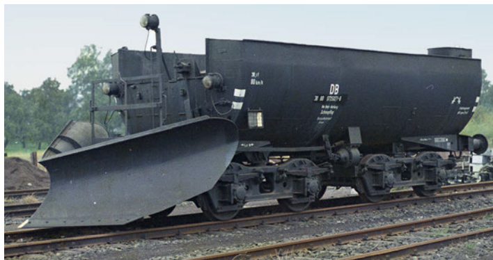
Der 1974 in Stade heimische Schneepflug 973 5 021 entstammt einer auf ausgemusterten Wannentendern der Baureihen 42 und 52 aufgebauten DB-Kleinserie. Modelle hiervon gibt es von Liliput in HO und N
