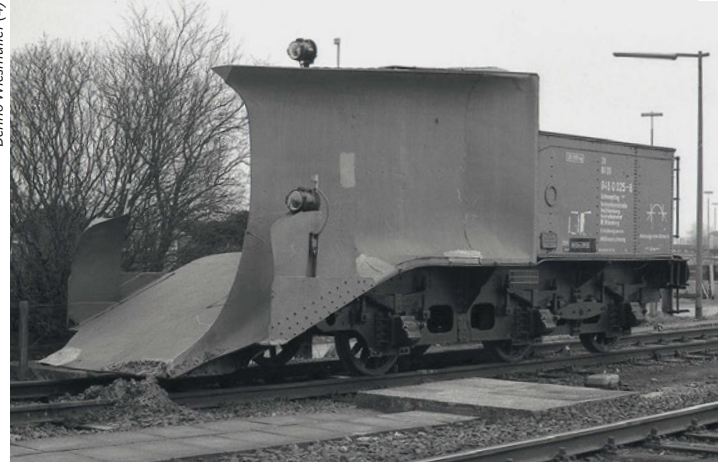
Beim Bw Oldenburg beheimatet war im März 1979 der Schneepflug 946 0 025. Sein 1930 im AW Harburg gebautes Räum schild war für die einseitige Gleisräumung auf mehrgleisigen Strecken ausgelegt
