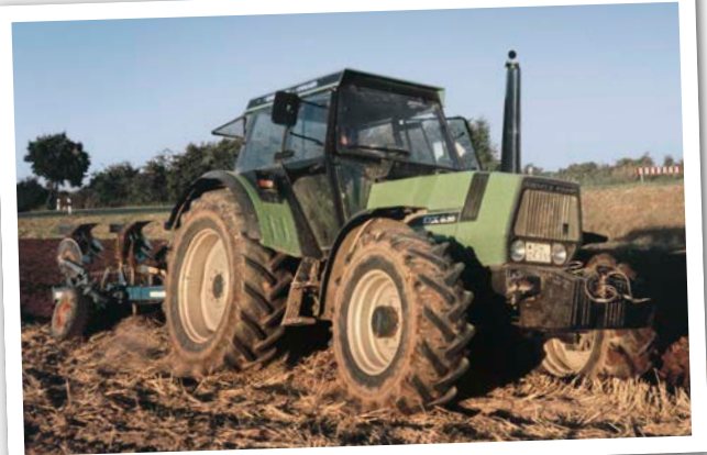
Der DX 6.30 löste bei Deutz-Fahr den DX 120 ab. Neu waren die 40-km/h-Option und die mittig angetriebene Vorderachse
