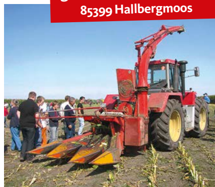
Euro Trac mit Pöttinger-Häcksler am Heck und gedrehtem Fahrerstand
