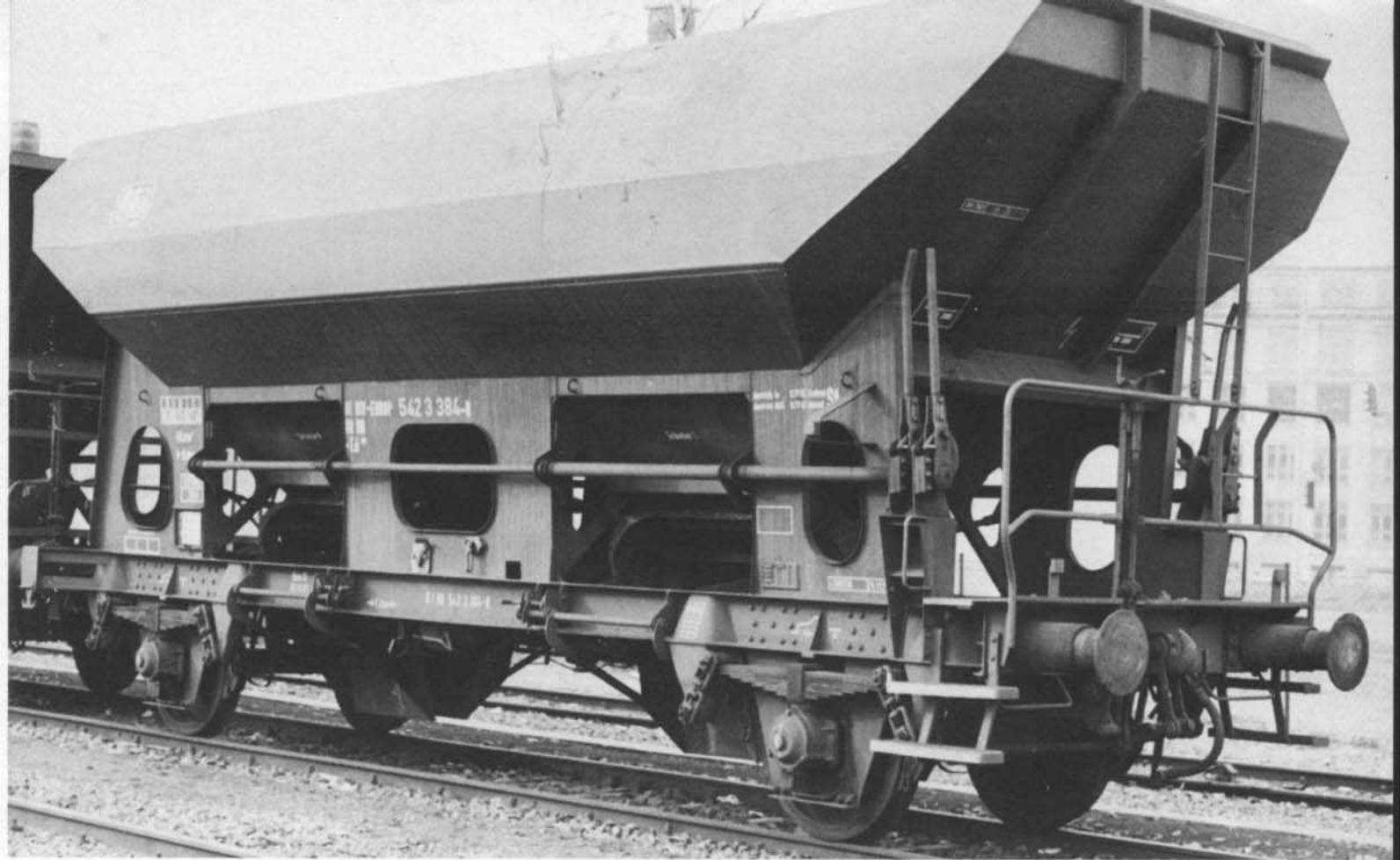
Bild 4: Einen etwas größeren Laderaum mit 33,5 m 3 hat dieser Wagen der Gattung Ed 086, der noch mit Einfachschaken am Federgehänge ausgestattet ist.
