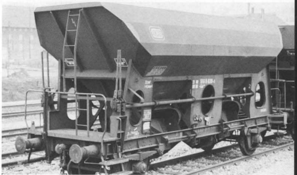
Bild 4: Einen etwas größeren Laderaum mit 33,5 m 3 hat dieser Wagen der Gattung Ed 086, der noch mit Einfachschaken am Federgehänge ausgestattet ist.
