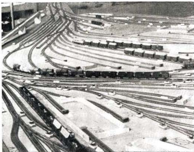
Bild 5 Großflächiges Eisenbahnmodell für Betriebsuntersuchungen an der Hochschule für Verkehrswesen
