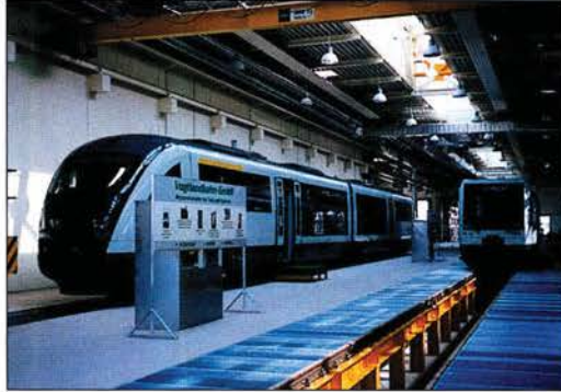
Ein neues Zuhause für die Regiosprinter der Vogtlandbahn: Die Nutzlänge der Gleise in der Wartungshalle beträgt 55 Meter.
