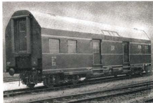
Bild 1 Doppelstockpackwagen Dpw 4g
