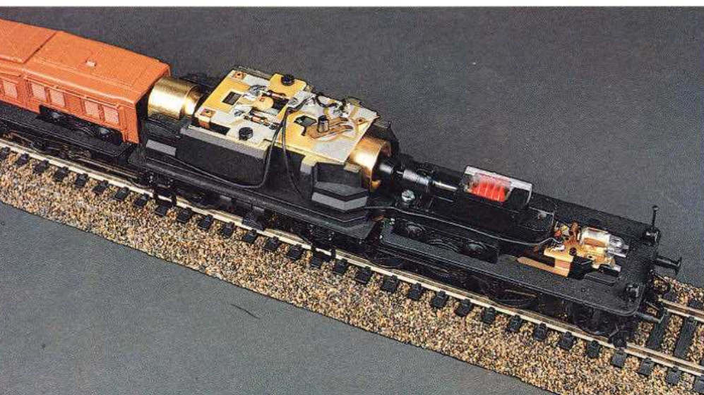
Bild 10: Der zentral angeordnete Motor hat zwei Wellenenden mit Messing-Schwungmassen. Über ein Schneckengetriebe wird die Blindwelle direkt angetrieben.
