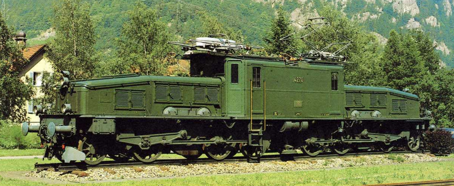
Bild 1: Beim Depot Erstfeld ist das grüne Krokodil mit der Betriebsnummer 14270 als Denkmal aufgestellt. Nach einem Umbau ist an jeder Seite nur noch ein Einstieg vorhanden.
