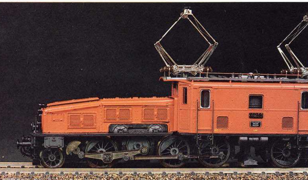
Bild 9: Die aus Präzisionsguß gefertigten Kuppelstangen übertragen das Drehmoment von der mittleren Blindwelle auf die drei Kuppelradsätze.
