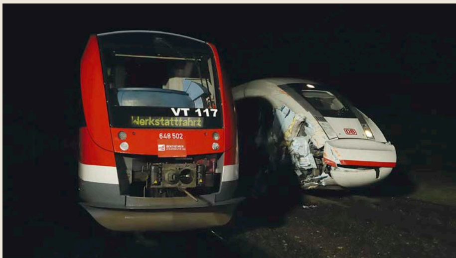
In Lauenbrück endet die Überführung am 15. November 2023 unerwartet, nachdem ein ICE 4 die abgestellte Dreiergarnitur bei einer Flankenfahrt touchiert und beschädigt hat
