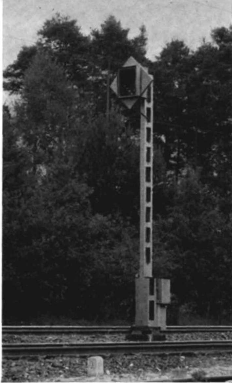
Abb. 6. Fahrregelungsanzeiger Zs 4 bzw. Zs 5 als Einzelmastsignal. (Foto: MIBA)
