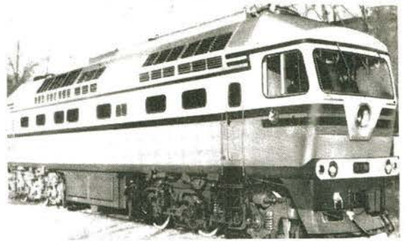
Bild 2 Ebenfalls für diesen Zweck wurde die 4000-PS-Lokomotive vom Typ „TEP—70“ in Kolomna gebaut.
